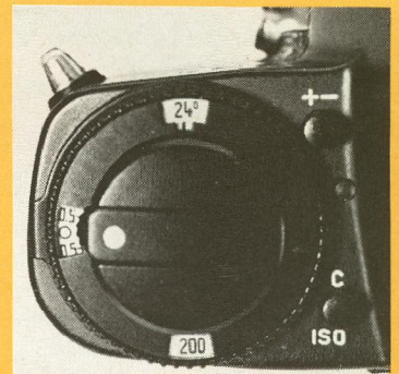
Tilbagepolingsknappen med ASA/ISO indstilling og ±2 trins korrektion ved auto C-knappen er batterikontrollen.
