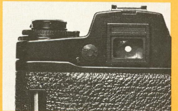
Søgerokulæret kan lukkes for at hindre falsk lys i at ramme lysmåler-cellen ved f.eks. stavoptagelser. Desuden vinduet til aflæsning af filmtype.
